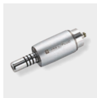
Micromotori i-XR3 Silenziosi, leggeri e versatili, i-XR3 e i-XR3L sono adatti ad interventi di odontoiatria conservativa e protesica. Velocità da 100 a 40.000 rpm e torque fino a 3.3 Ncm.
